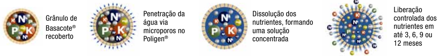
Grânulo de fertilizante com recorte do Polímero Elástico.
