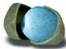
Grânulo de fertilizante com recorte do Polímero Elástico.
